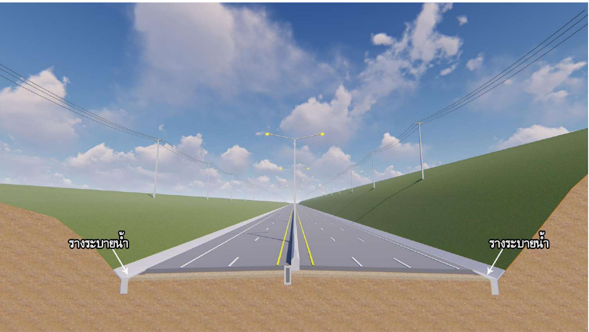
รูปที่ 2.4.7-2 ระบบระบายน้ำตามแนวยาวของทางหลวงโครงการ 2
