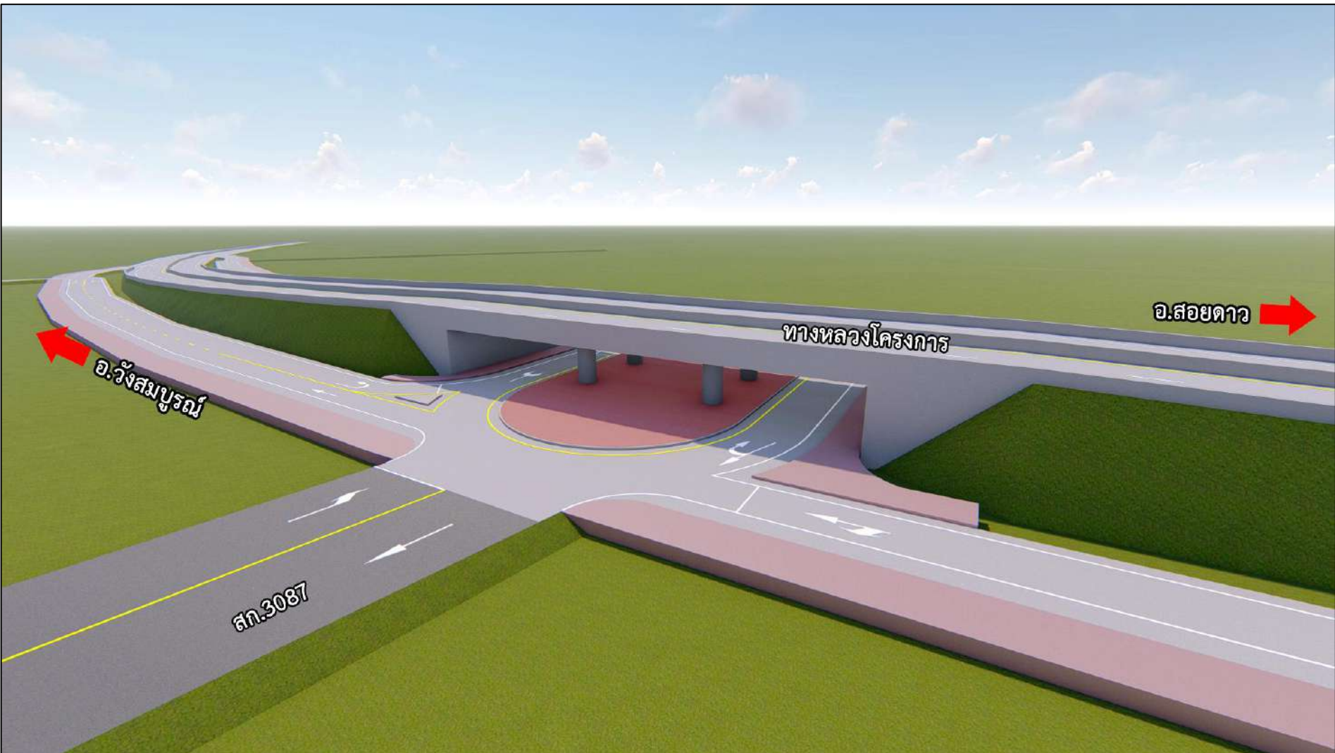
รูปที่ 2.2.1-7 รูปแบบจุดกลับรถแบบลอดใต้สะพานบก
