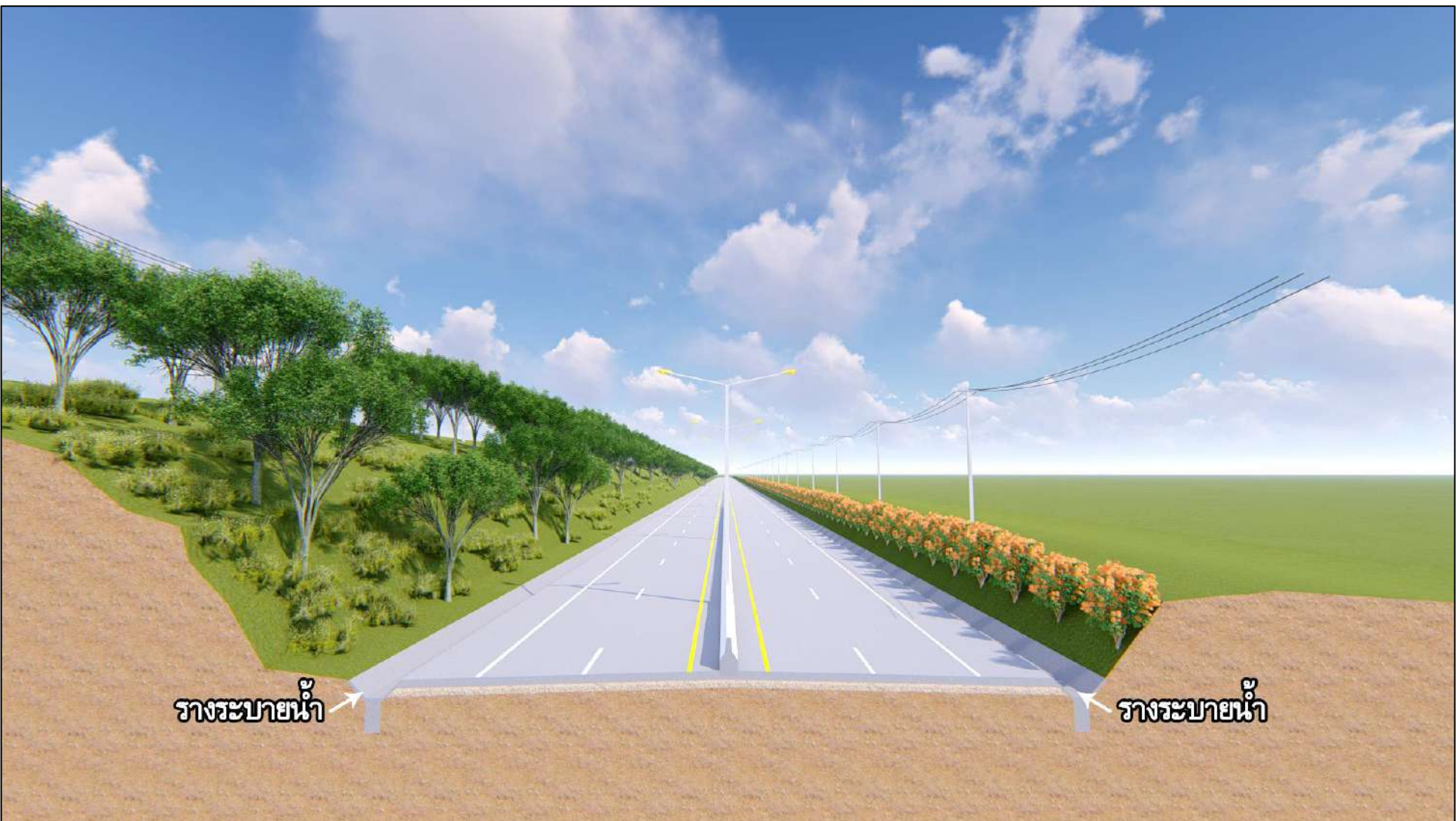
รูปที่ 2.4.7-1 ระบบระบายน้ำตามแนวยาวของทางหลวงโครงการ 1
